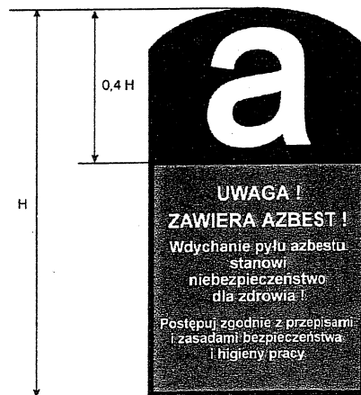
Oznakowanie wyrobów i odpadów zawierających azbest
