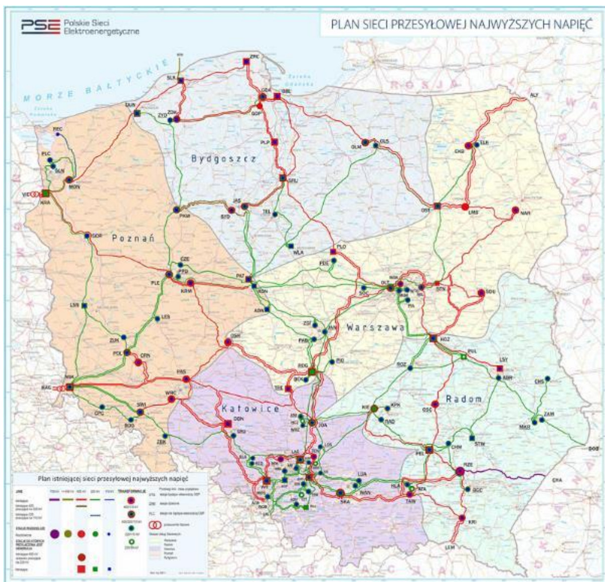
Rysunek 4 Schemat Krajowej Sieci Przesyłowej Źródło: PSE, https://www.pse.pl/dane-systemowe/praca-kse/informacje-ogolne/schemat-sieci
