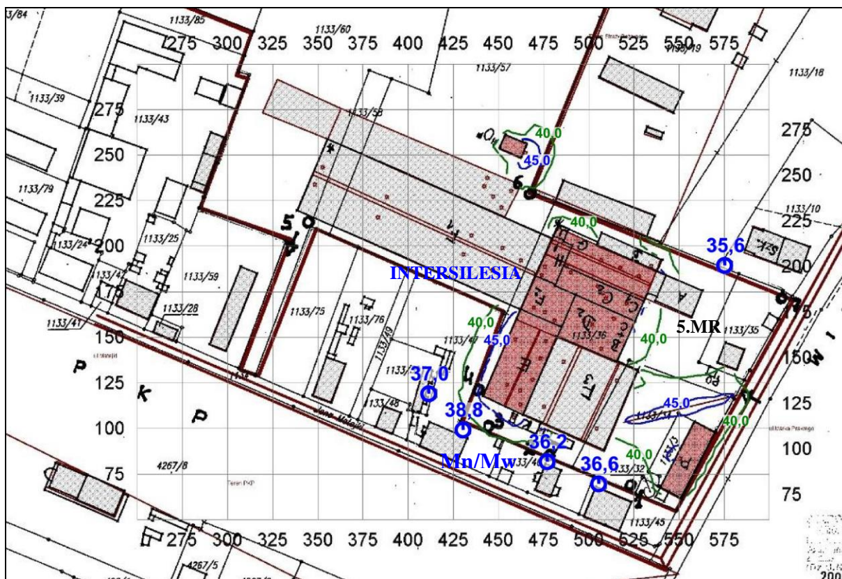
Rys. 4.3: Rozbudowa mieszalni Intersilesia Sp. z o.o. - wykres izofon w porze nocnej
