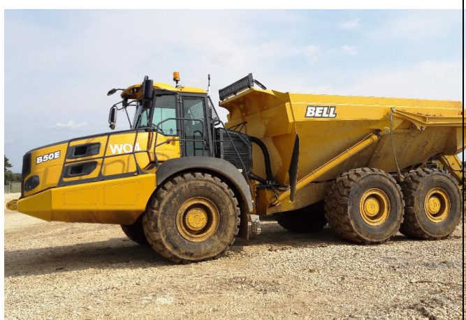
Foto 15: Wozidło technologiczne Beel B50, ładowność 50 ton
