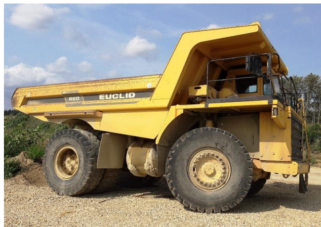
Foto 12: Wozidło technologiczne Euclid R60, ładowność 60 ton
