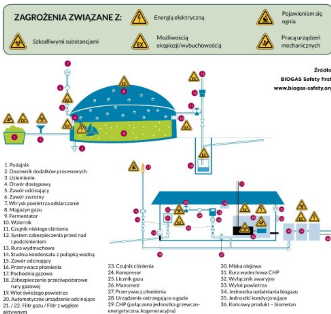
Rysunek 10 Schemat kluczowych dla bezpieczeństwa stref w biogazowni z instalacją biometanowni. 22
