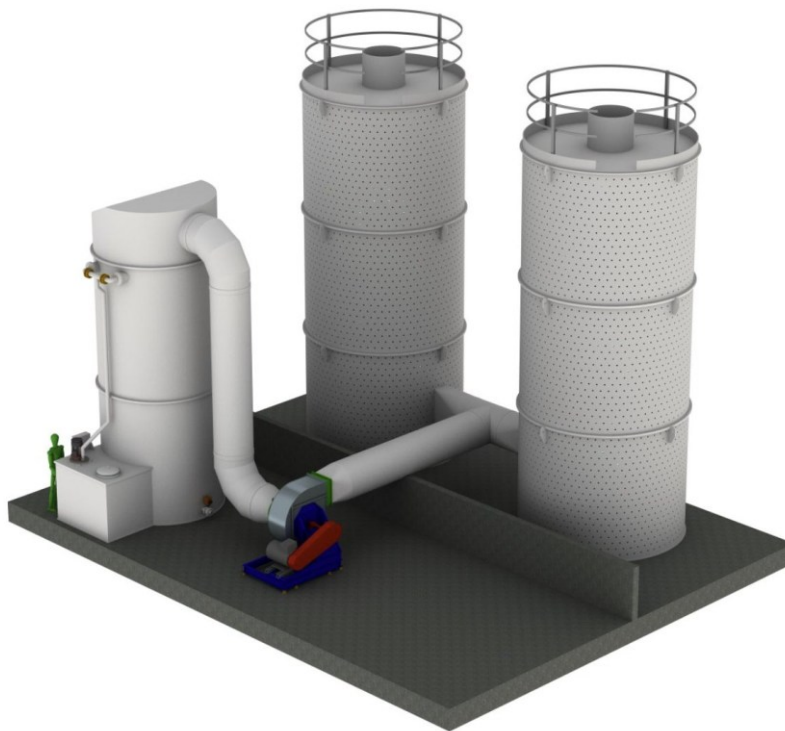
Rysunek 1 Poglądowy projekt układu oczyszczania powietrza w wersji systemu 2-stopniowego. [materiał WLW W.Kocoń M.Joński Spółka Jawna]
