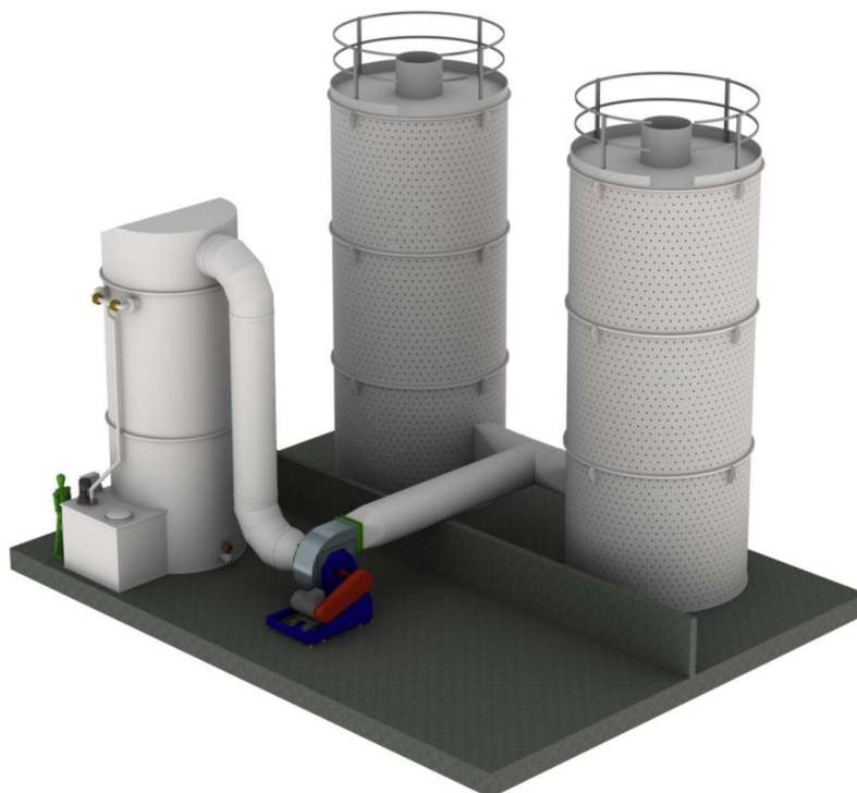
Rysunek 1 Poglądowy projekt układu oczyszczania powietrza w wersji systemu 2-stopniowego. [material WLW W.Kocóń M.Joński Spółka Jawna]
