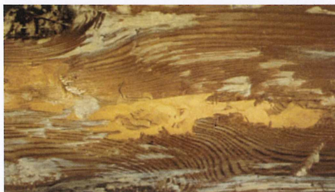
Widoczne świeże żerowiska Spuszczela pospolitego
