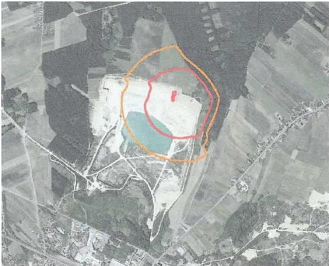
Ryc. 15 Zasięg oddziaływania akustycznego wiertnicy podczas nawiercania otworów przed wykonaniem odstrzału.
