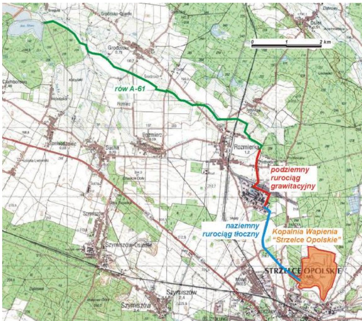
Rys. 25. System zrzutu wód kopalnianych z odwadniania Kopalni Wapienia „Strzelce Opolskie” do rzeki Suchej
